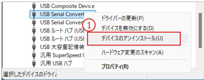
①USB Serial Converter A と B を右クリックして表示されるメニューから「デバイスのアンインストール」をクリックしてください。
