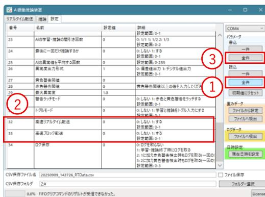
① AI Vibration Inference Host ソフトの「設定」タブをクリックし、読み込み→全件 ボタンをクリックして評価ボードから設定を読み込みます。
