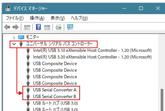
※DT-EBML63Q2557 評価ボード以外に USB シリアル変換ケーブルが接続されている場合、USB Serial Converter A と B が複数表示される場合があります。
