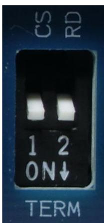
DIP スイッチは入力信号のターミネータの有効/無効を切り換えます。通常は、接続対象機器と、1 対 1 で通信をする場合は、ターミネータを有効にしてください。
